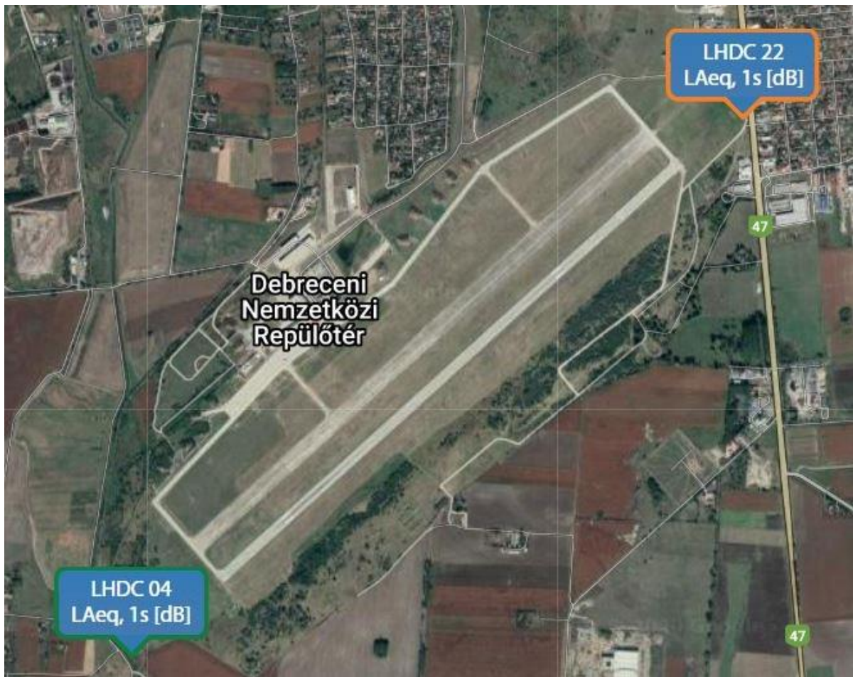
1. ábra: Zajmonitor pontok elhelyezkedése a Debreceen Nemzetközi Repülőtéren
